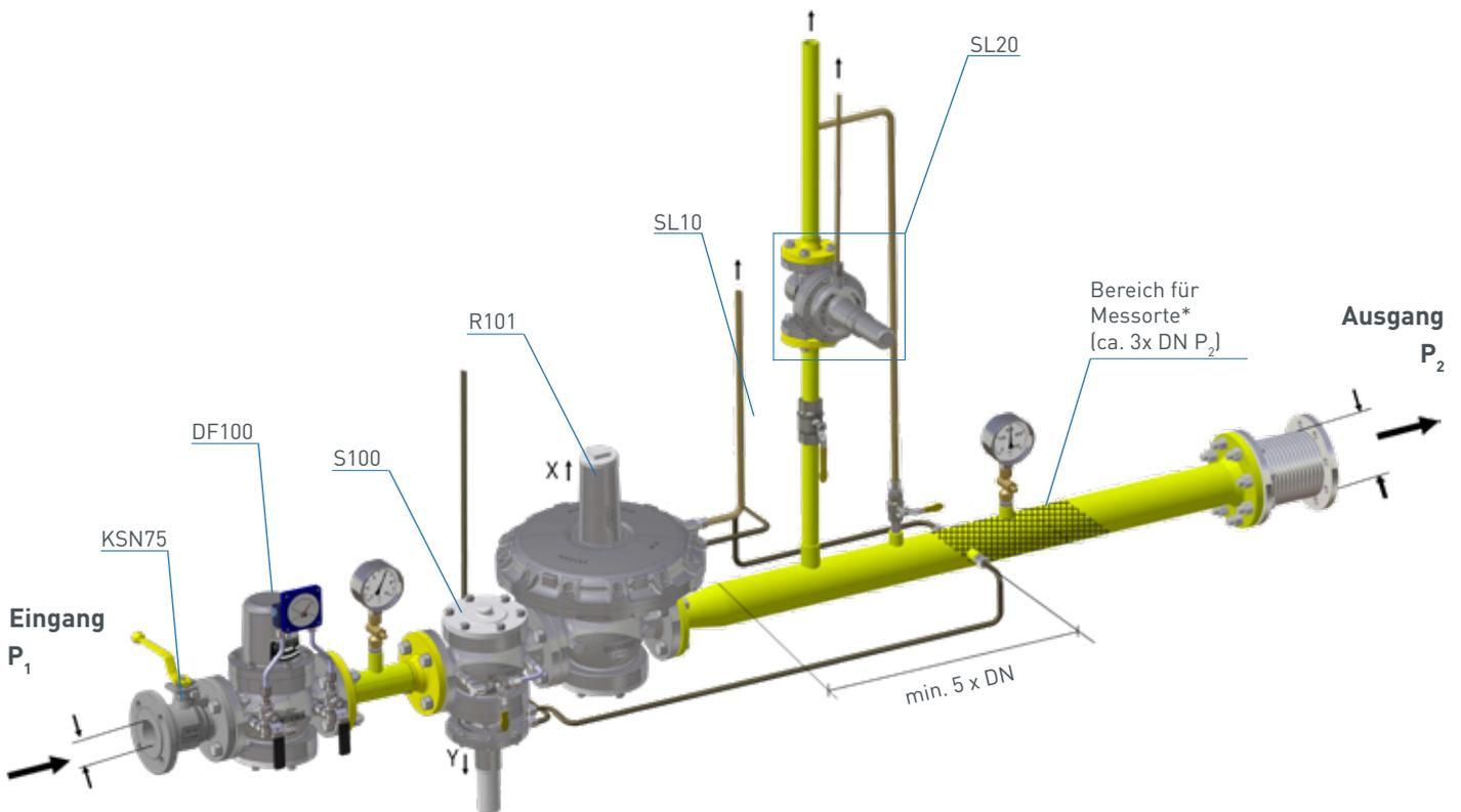
\*) Empfohlene Gasgeschwindigkeit am Messleitungsanschluss max. 25 m/s
